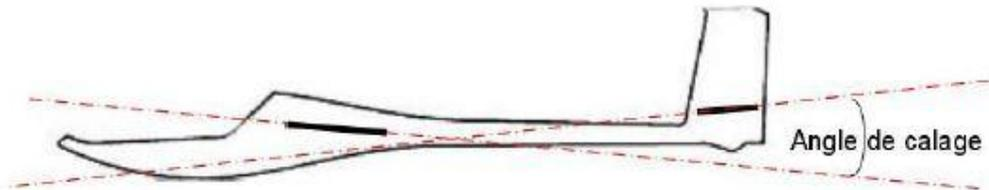
Le calage aile/stabilisateur est une opération cruciale dans le réglage d'un planeur et d'un avion.
